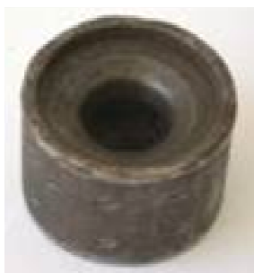
Рис. 5. Фильера для правки строительной арматуры
