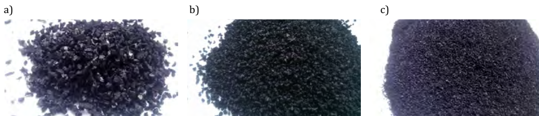
Rys. 1. Materiał pochodzący z recyklingu opon samochodowych: a) granulaty gumowy o frakcji 4–6 mm; b) granulaty gumowy o frakcji 2–4 mm; c) miął o frakcji poniżej 1 mm
