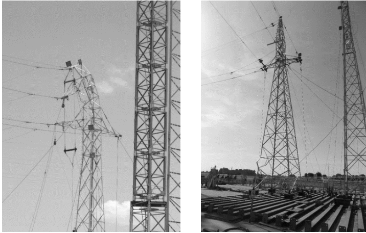
Rys. 5. Schematy zniszczenia słupów jednotorowych EN111 [7]
